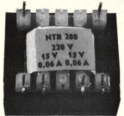
Afb. 47. In de handel is deze trafo verkrijgbaar die ook secundair 2 \times 15 \text{ V} levert. Voor ons doel is deze trafo niet bruikbaar vanwege de te geringe uitgangsstroom.
